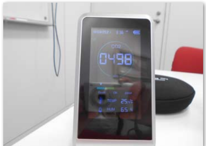
二酸化炭素計測器を設置し換気が行われているか確認
